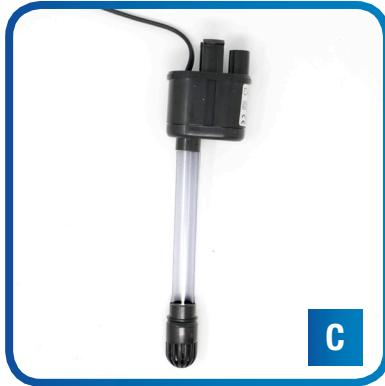
Das Auslaufrohr (4) auf die Pumpe (3) setzen
